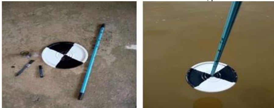
Figura 1: O Disco de Secchi construído com materiais de baixo custo, para medir a turbidez da água.
