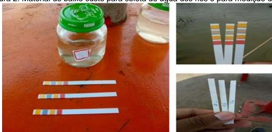
Figura 2: Material de baixo custo para coleta de água dos rios e para medição do Ph.
