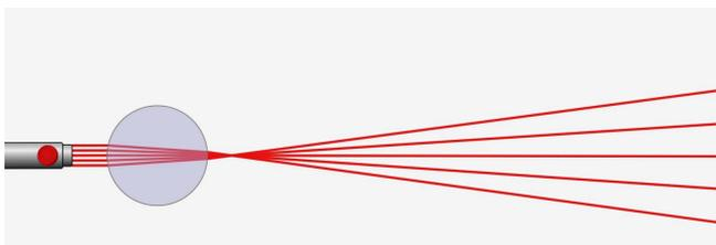
Ilustração 1: Esquema da gota d'água como lente esférica.
