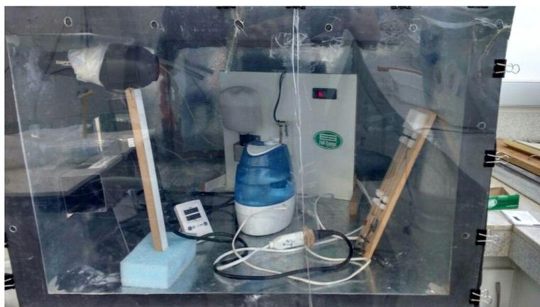
**Câmara para controle de condições (umidificação, desumidificação e temperatura).**
