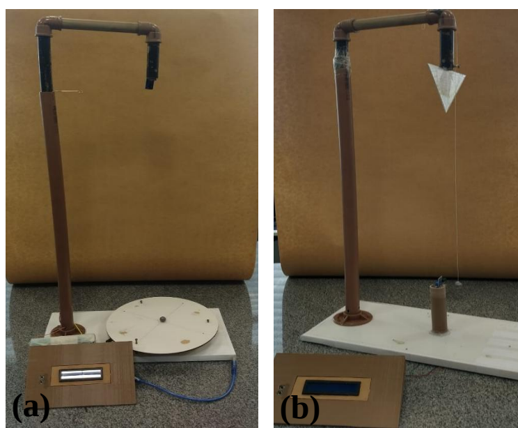
Figura 1: Aparatos: (a) queda livre e (b) pêndulo simples.
