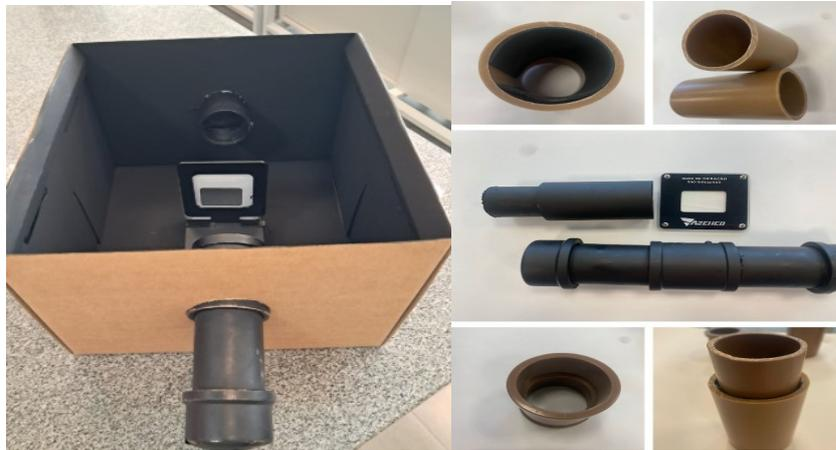
**Figura 2:** Câmara escura para impedir entrada de luz externa, canos de PVC e rede de difração utilizados.
