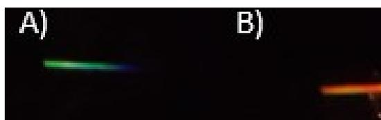
**Figura 5:** Espectro de emissão do cobre (A) e do sódio (B) obtidos por meio do Espectroscópio elaborado.
