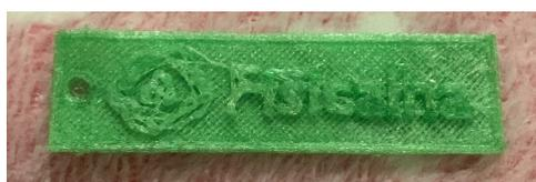
**Figura 5:** Chaveiro produzido na impressora 3D a partir de filamentos de garrafa PET.
