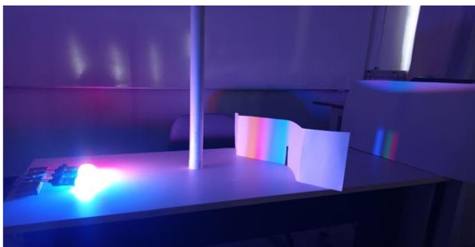
**Figura 1.** Montagem do experimento das sombras coloridas com lâmpadas de LED RGB.
