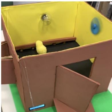
Figura 1: Aviário automatizado com Arduino UNO.
