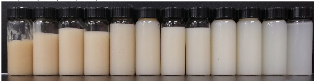
Figura 1 – Soluções de lecitina em água, da esquerda para a direita 20 %, 15 %, 12,5 %, 10 %, 8 %, 7 %, 6 %, 5 %, 4 %, 3 %, 2 % e 1 %.
