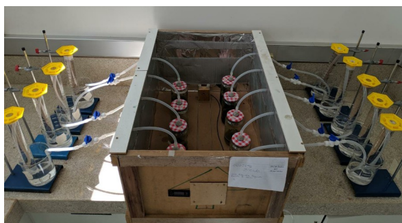
Figura 2. Sistema para armazenar os biodigestores e mensurar o volume de biogás diário.
